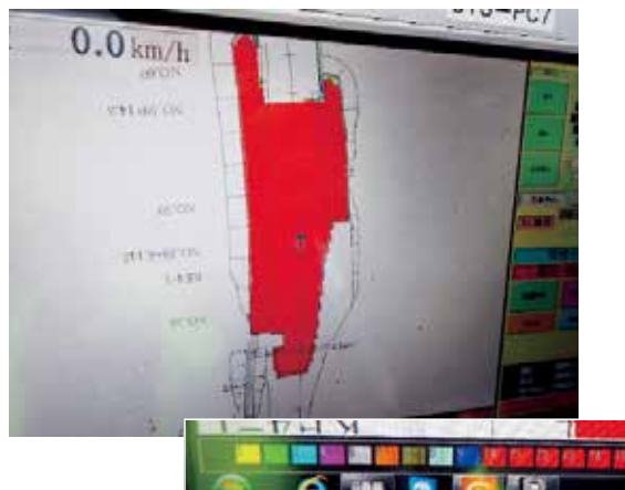
写真10 ICT建機による締固め状況
