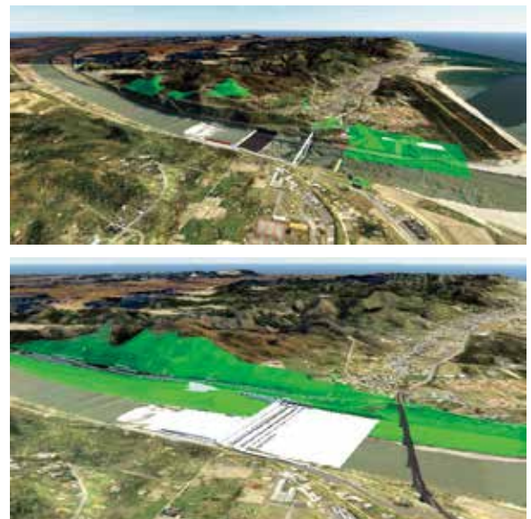
図5 山地掘削施工計画検討モデル (上: 現在、下: 完成予想図)
