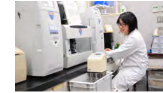
イオンクロマトグラフにて試料中のイオン濃度を測定
