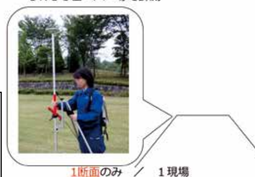
GNSSローバー等で計測
