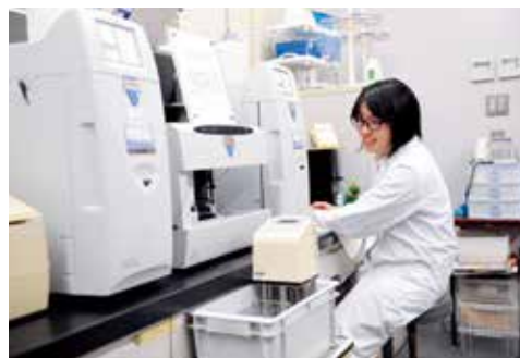
イオンクロマトグラフにて試料中のイオン濃度を測定
