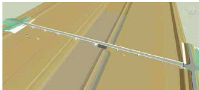
河川を渡河する鋼連続箱桁橋のCIM事例
